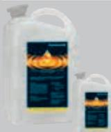
Zum Mischen mit Wasser. 5% Öl = für normale Baustähle sowie alle NE-Metalle, 10% Öl = für Stähle höherer Festigkeit, auch Edelmetalle. Für schwierigste Zerspanungsprobleme kann bis zu 50% Öl ins Wasser gemischt werden. Auch pur anwendbar. Ideales Öl für alle Zerspanungsarbeiten. Zum Einfüllen, z.B. in Karnasch Kühlmitteldruckflaschen.
