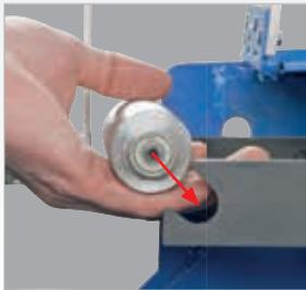
► Einfaches, schnelles und werkzeugloses Wechseln der Schleifrolle durch optimierte Schnellwechselhalterung
