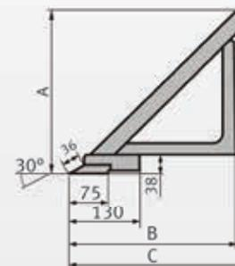
Abmessung Biegearme MSBM
