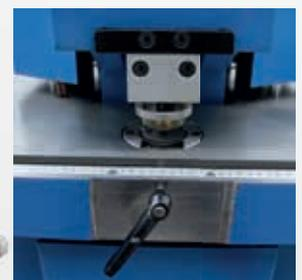
▶ Stanzstation mit 12 Tonnen Stanzdruck an der Rückseite
