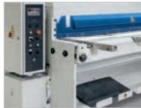
▶ *Bedienpult an der linken Maschinenseite*
