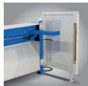
▶ *Rückraum durch Lichtvorhang abgesichert*
